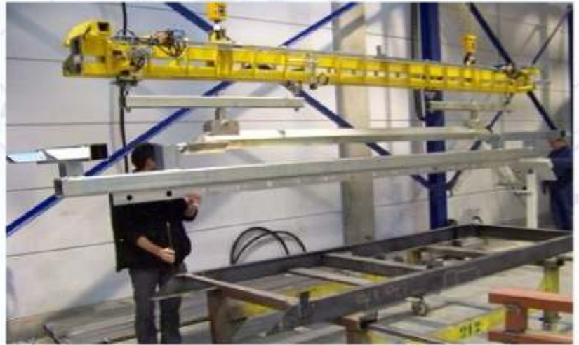
Puesto de carga para una línea de cataforesis
